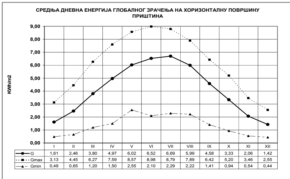
Слика 9.1.8: Средња дневна енергија глобалног зрачења на хоризонталну површину, Приштина
