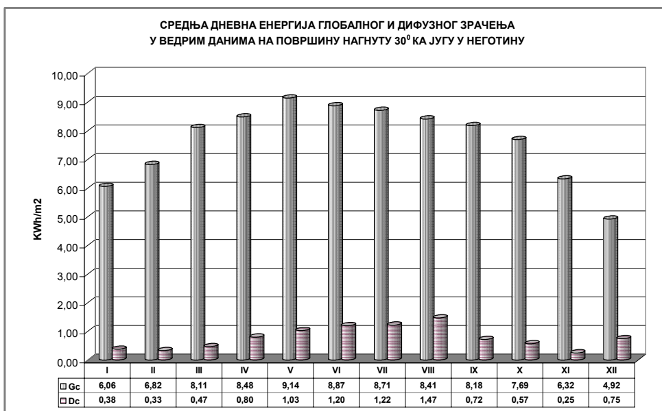
Слика 9.1.31: Средња дневна енергија глобалног и дифузног зрачења у ведрим данима на површину нагнута 30° ка југу у Неготину
