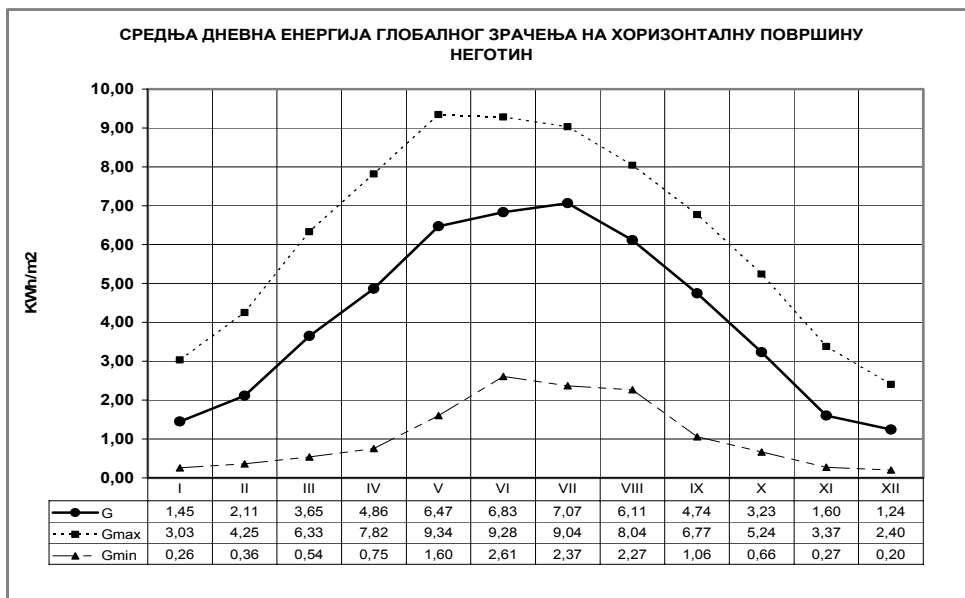
Слика 9.1.6: Средња дневна енергија глобалног зрачења на хоризонталну површину, Неготин
