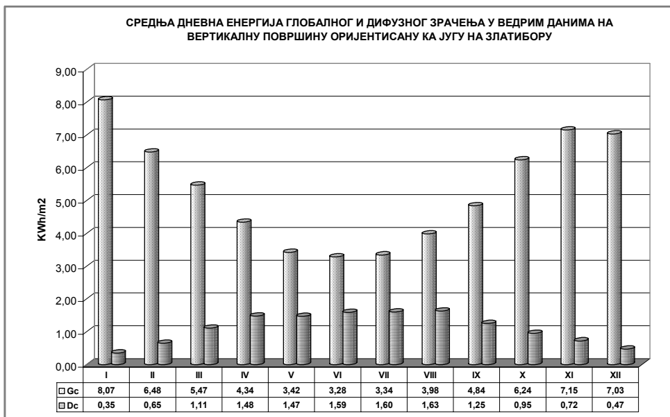
Слика 9.1.45: Средња дневна енергија глобалног и дифузног зрачења у ведрим данима на вертикалну површину оријентисану ка југу на Златибору
