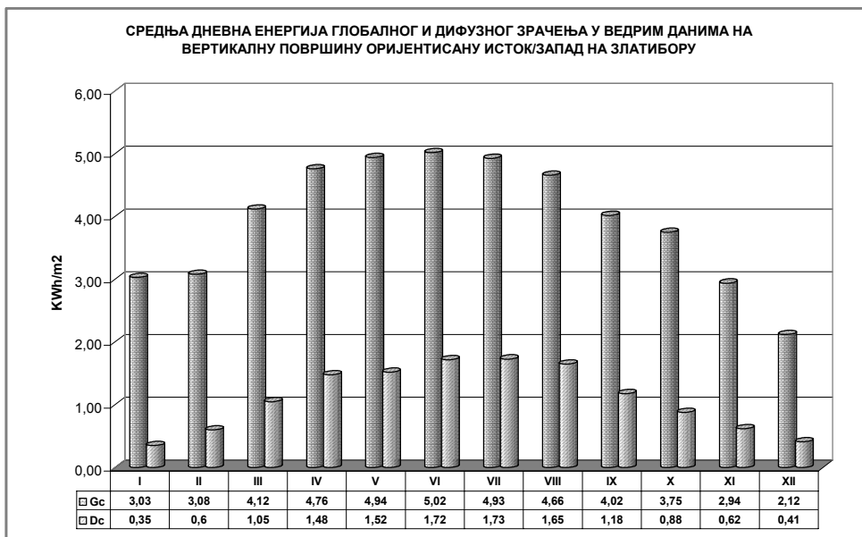
Слика 9.1.47: Средња дневна енергија глобалног и дифузног зрачења у ведрим данима на вертикалну површину оријентисану исток/запад на Златибору
