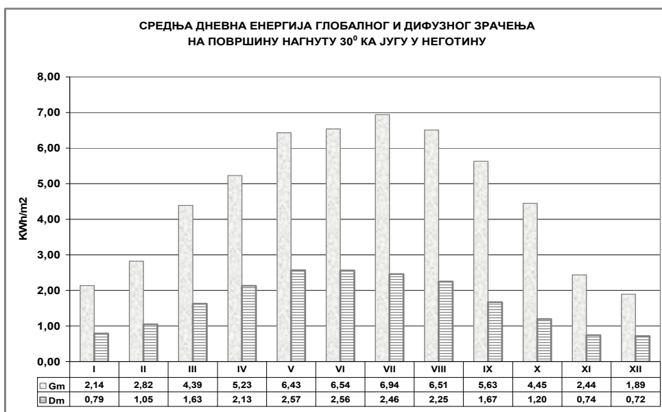
Слика 9.1.30: Средња дневна енергија глобалног и дифузног зрачења на површину нагнута 30° ка југу у Неготину
