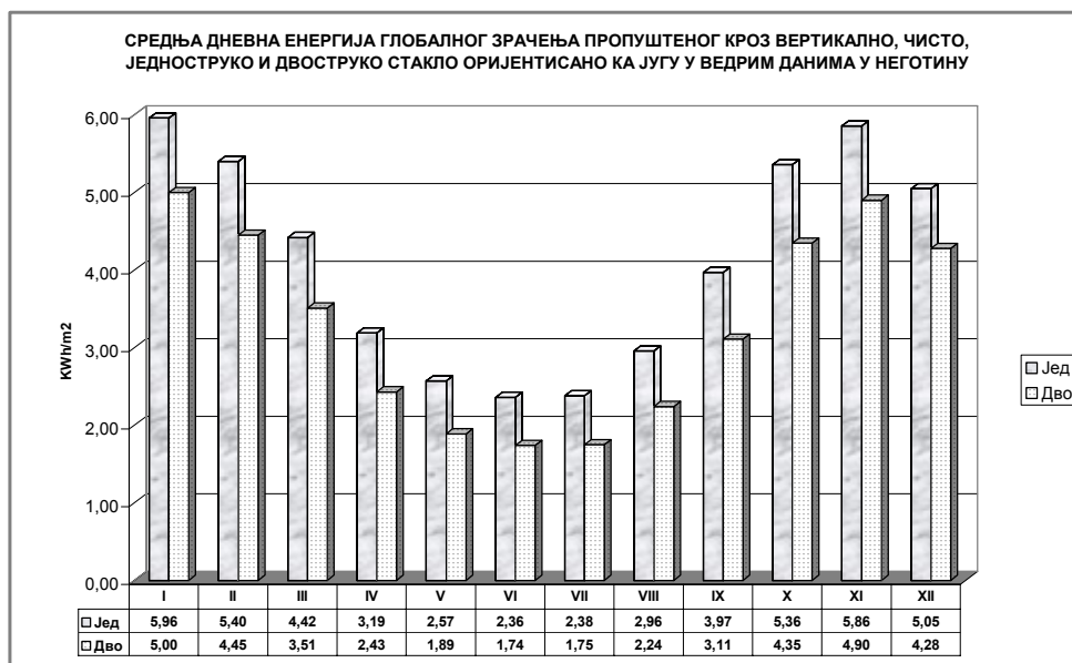
Слика 9.1.37: Средња дневна енергија глобалног зрачења пропушеног кроз вертикално, чисто, једноструко и двоструко стакло оријентисано ка југу у ведрим данима у Неготину
