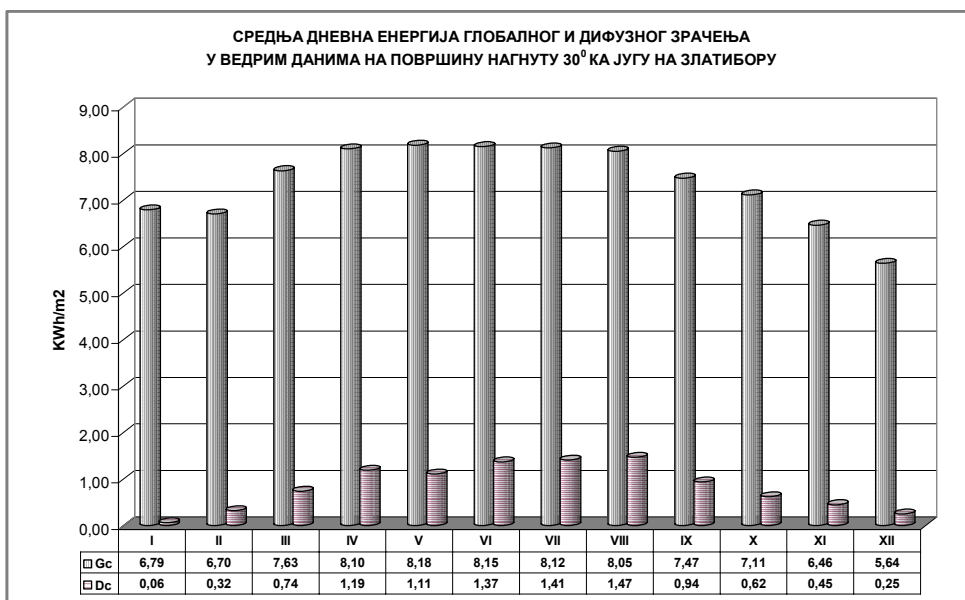
Слика 9.1.43: Средња дневна енергија глобалног и дифузног зрачења у ведрим данима на површину нагнута 30° ка југу на Златибору
