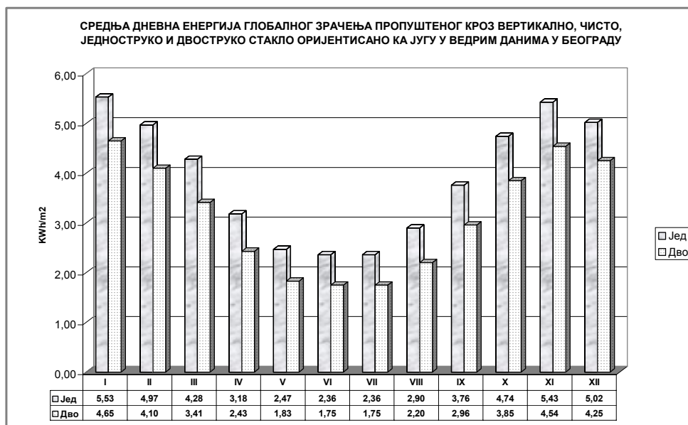
Слика 9.1.25: Средња дневна енергија глобалног зрачења пропушеног кроз вертикално, чисто, једноструко и двоструко стакло оријентисано ка југу у ведрим данима у Београду
